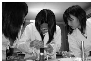
試料濃度を高めに設定してあり、旋光度の確認は、分かりやすいように最も暗く見える点でおこなうようにしたので、どのグループも偏光面の回転が目で確認できていた。あらかじめ説明はしている、何も入れないときに比べて明らかに偏光板の角度が変わっていることは新鮮に感じていたようである。
